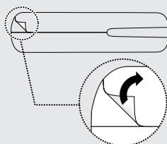
**SCHRITT 1.** Im Lieferumfang sind zwei Folien zum Aufkleben enthalten. Zum Auftragen ziehen Sie einfach das Trägerpapier von der Folie ab.
