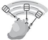
**ÜBERLAPPENDE SCHWÜNGE** Achten Sie darauf, dass Sie mit jedem Schwung den vorigen ein wenig überlappen, um sicherzustellen, dass der gesamte Bodenbereich abgesehen wurde.
