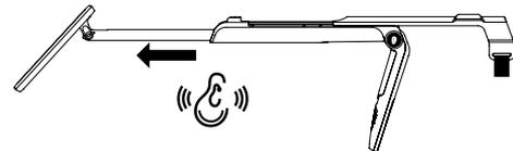
① Zum Einziehen des Gestänges tippen Sie fest auf den Sockel der Suchspule.
