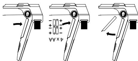
**SCHRITT 2.** Setzen Sie 4 x 1,5V AA (LR6) Batterien ein (nicht im Lieferumfang enthalten).
