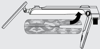
**SCHRITT 2.** Bringen Sie dann die gewählte Folie wie abgebildet auf dem Detektorgehäuse an.
