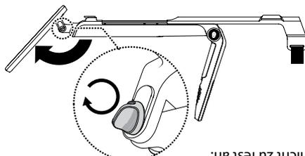
**SCHRITT 4.** Klappen Sie die Suchspule heraus, um parallel zum Boden zu suchen (siehe „Grundlagen zum Auffinden“). Ziehen Sie die Mutter an, um die Spulenposition zu fixieren. Ziehen Sie die Mutter nicht zu fest an.
