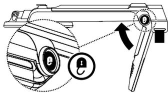
① Zum Entriegeln des Griffs halten Sie beide Entriegelungsstangen gedrückt, während Sie den Griff nach zusammenklappen. (Wenn Sie den Griff nicht korrekt entriegeln, kann dies zu Schäden führen.)
